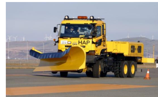
▲稚内空港／除雪自動化実証実験
